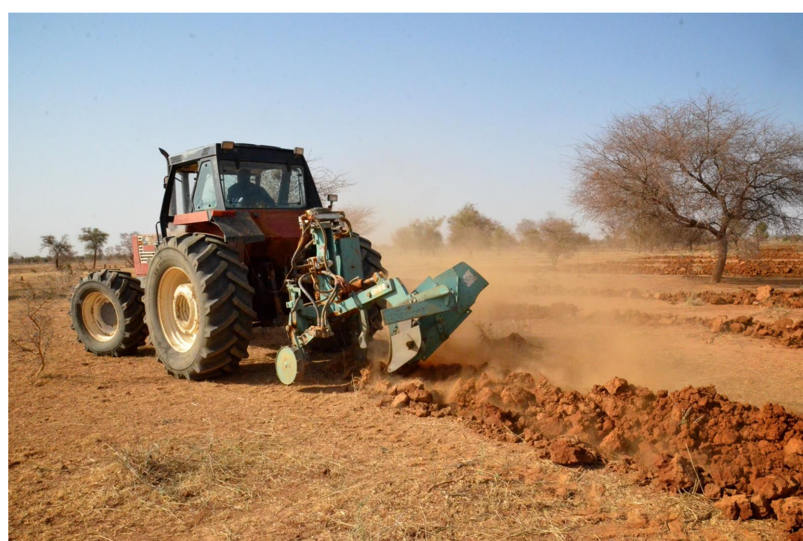
Halve maantjes aangelegd met de Valleranitechniek. Demi-lunes établies selon la technique Vallerani.
